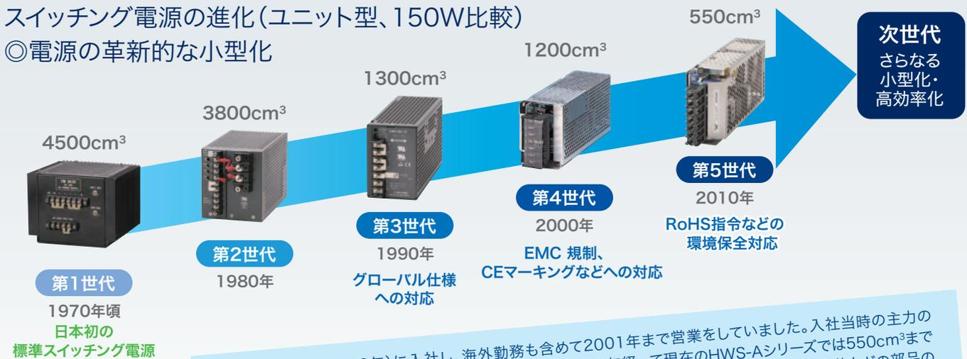
私は1985年(昭和60年)に入社し、海外勤務も含めて2001年まで営業をしていました。入社当時の主力の150W電源はHRシリーズで体積は3,800cm<sup>3</sup>。それから30年経って現在のHWS-Aシリーズでは550cm<sup>3</sup>まで小さくなり、80%以上小型化されています。これは、回路技術の進化、磁性材料の高性能化、半導体などの部品の小型化が寄与しています。これからもデジタル制御技術による高効率化、そしてIoTに適した次世代電源を開発していきますので是非ご期待ください。また裏面には貿易管理の観点で、電源を搭載した装置の輸出時の該非判定書について記載しておりますので、是非ご覧ください。
