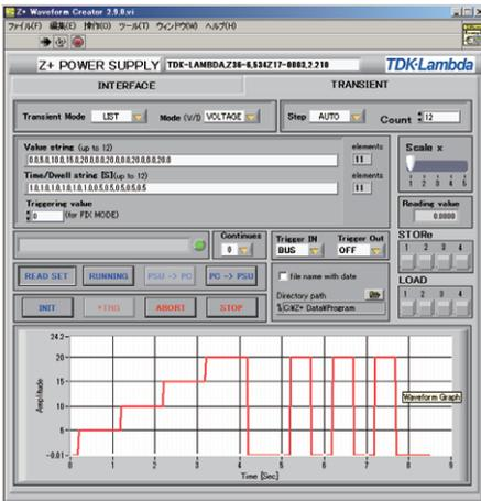
出力電圧、電流の任意波形を4パターンまで電源本体に保存できます。
