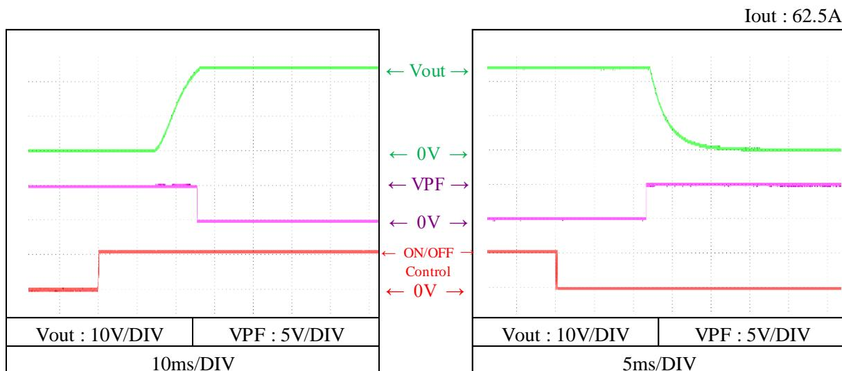
(a) リモートON/OFFコントロール端子によるON/OFF
