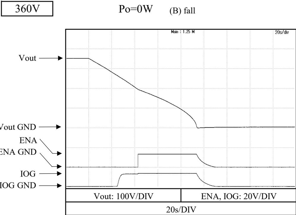
2.10 IOG、ENA信号 对 出力電圧 IOG and ENA signals vs. output voltage
