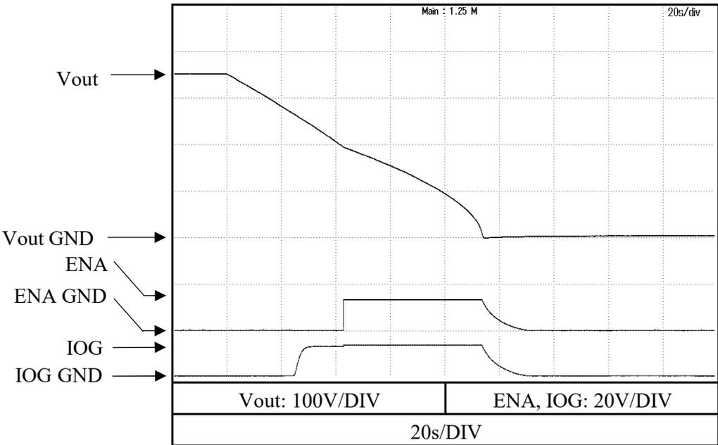
2.10 IOG、ENA信号 对 出力電圧 IOG and ENA signals vs. output voltage
