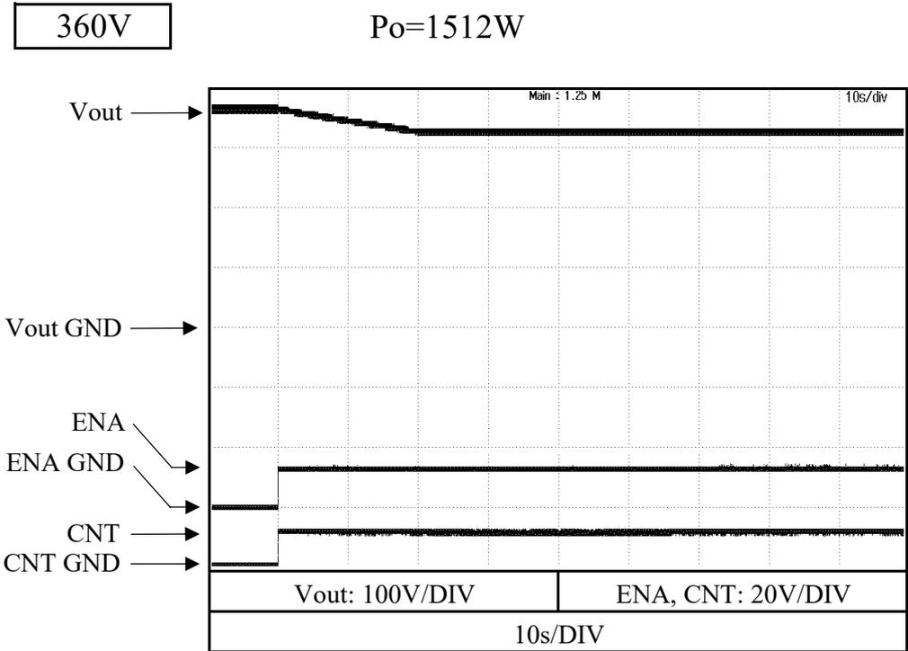
2.10 IOG、ENA信号 对 出力電圧 IOG and ENA signals vs. output voltage
