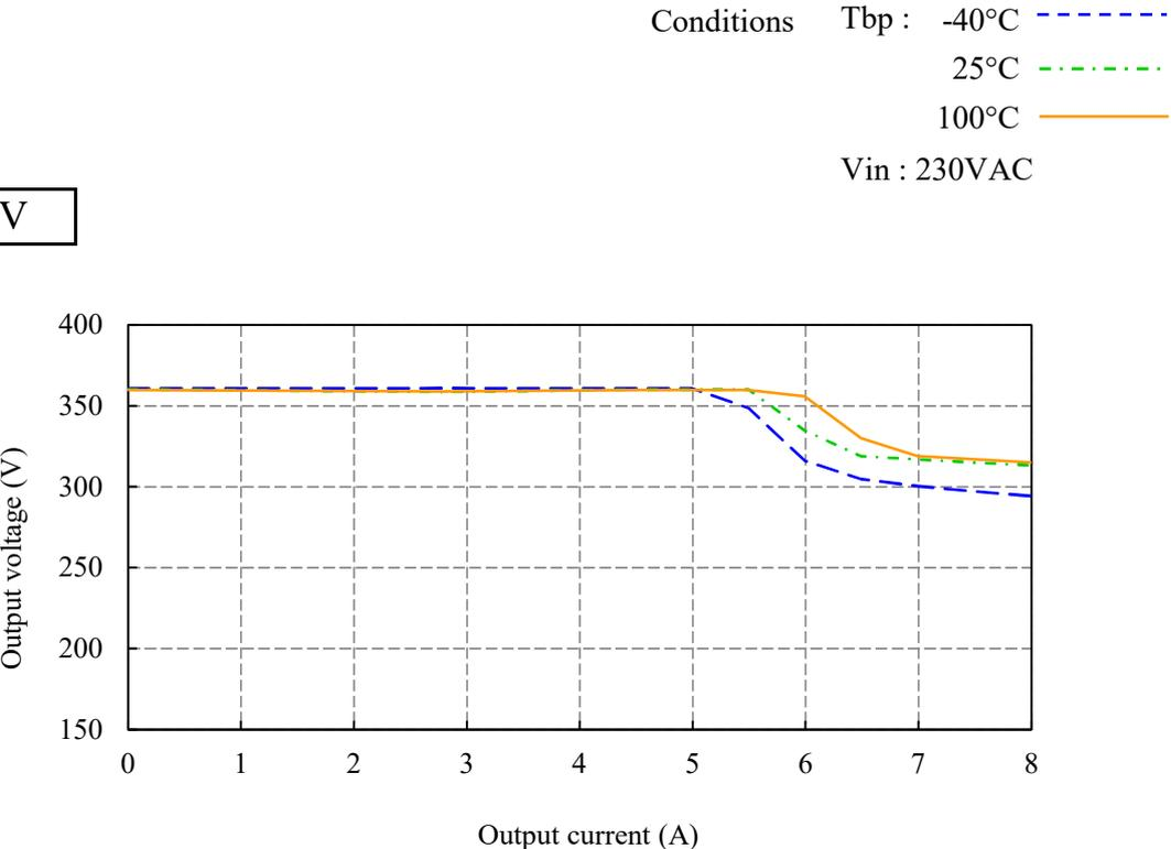
2.4 電流制限特性 Current limit characteristics
