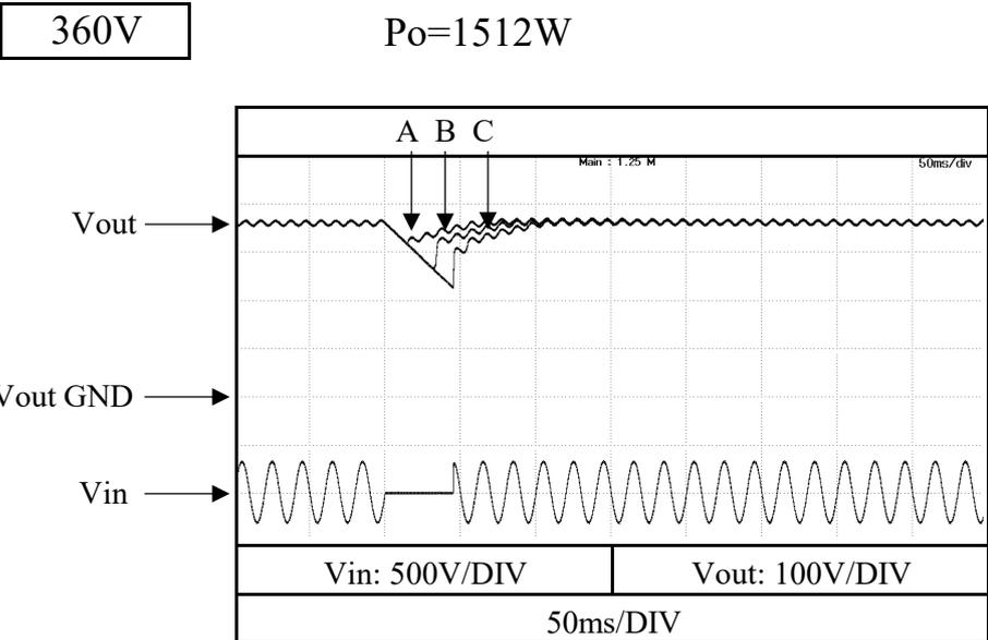
2.14 入力サージ電流(突入電流)波形 Inrush current waveform
