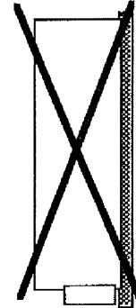
電源を装置に実装する場合、標準取付方法(A)以外に、上記の(B)～(E)がありますが、(D),(E)の取付は電源内部に熱がもる為、使用不可です。
