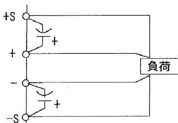
+S端子/+端子、-S端子/-端子のショート板を取り外し、左図の様な配線を行って下さい。
