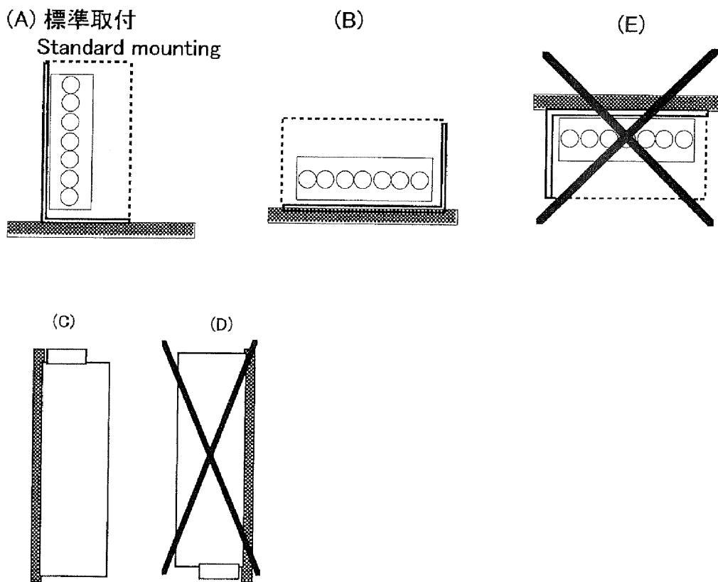
電源を装置に実装する場合、標準取付方法(A)以外に、上記の(B)～(E)がありますが、(D),(E)の取付けは電源内部に熱がもる為、使用不可です。
