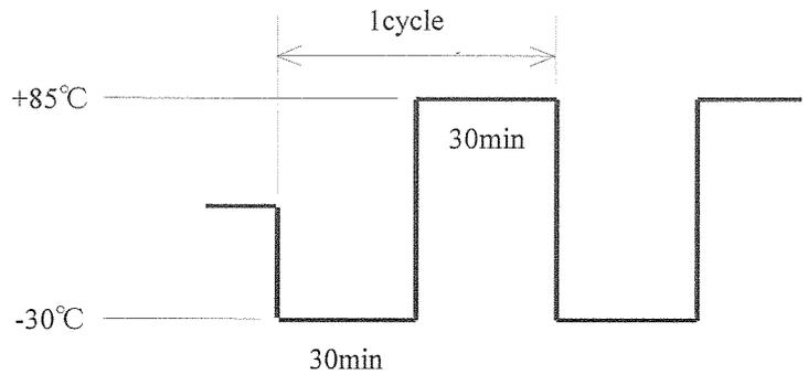
(3) 試験方法 Test Method
