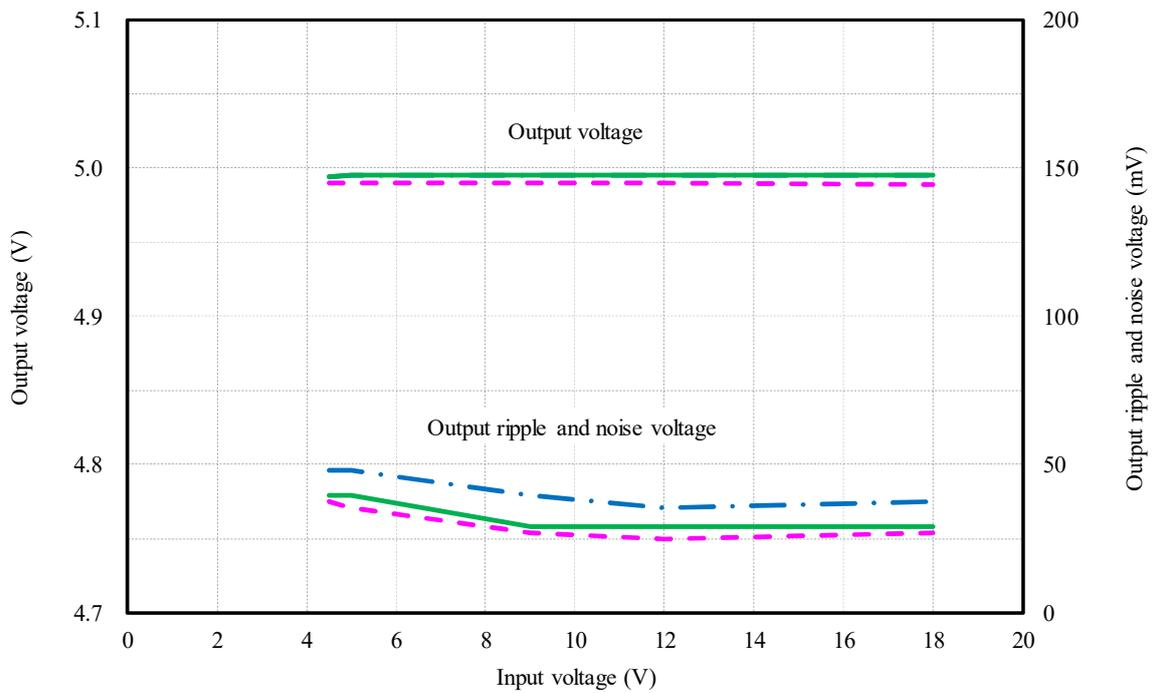
(2) 出力電圧・出力リップルノイズ電圧 対 入力電圧
