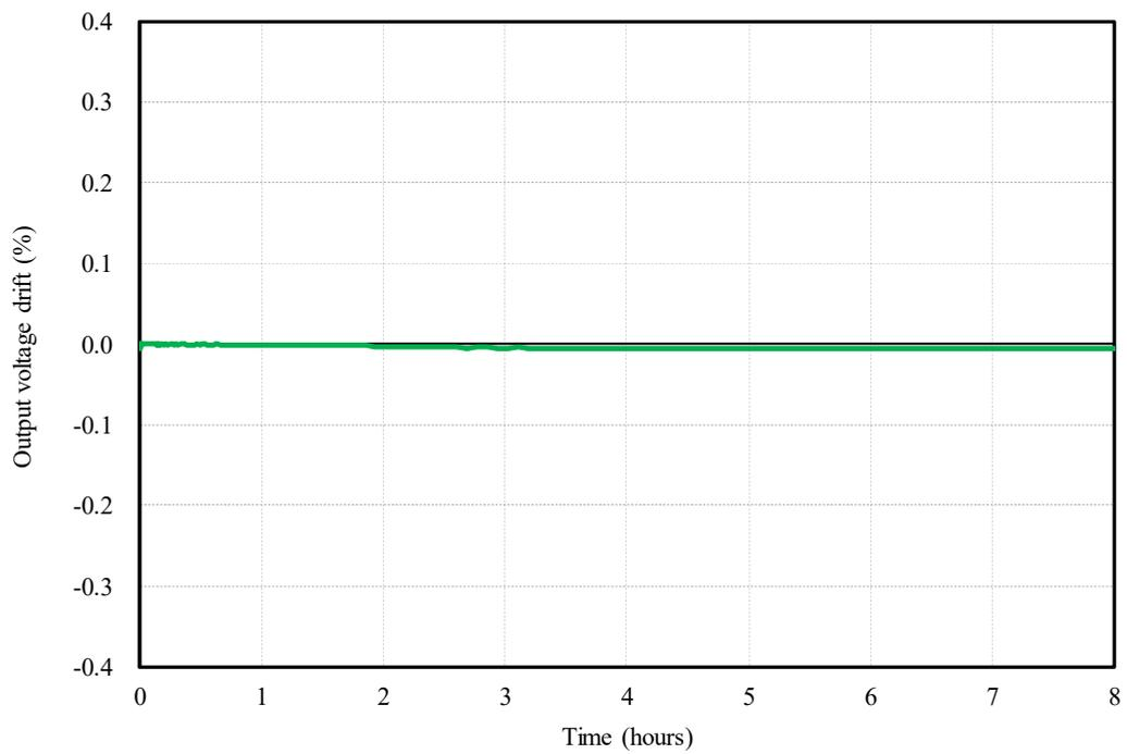
2-3. 通電ドリフト特性 Warm up voltage drift characteristics
