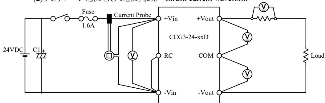
(3) 出力リップルノイズ電圧、波形 Output ripple and noise voltage and waveform
