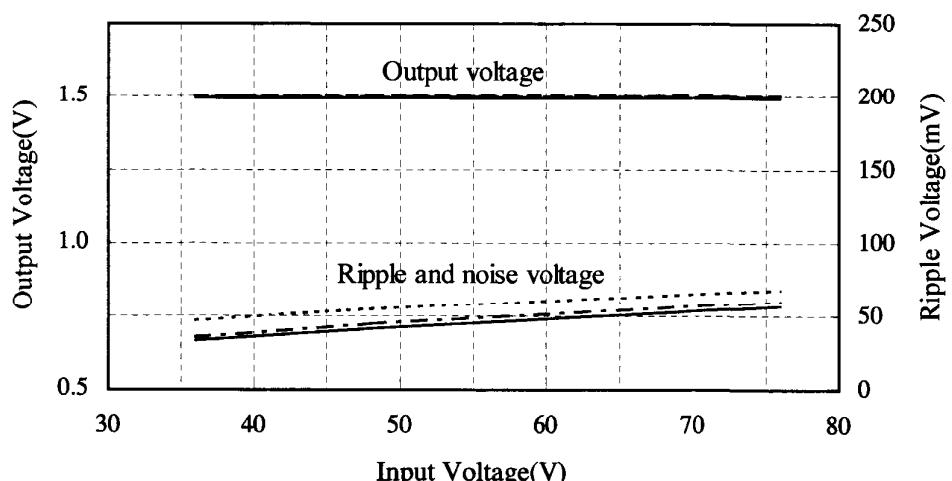
2.1 (2) 出力電圧、リップル電圧対入力電圧
