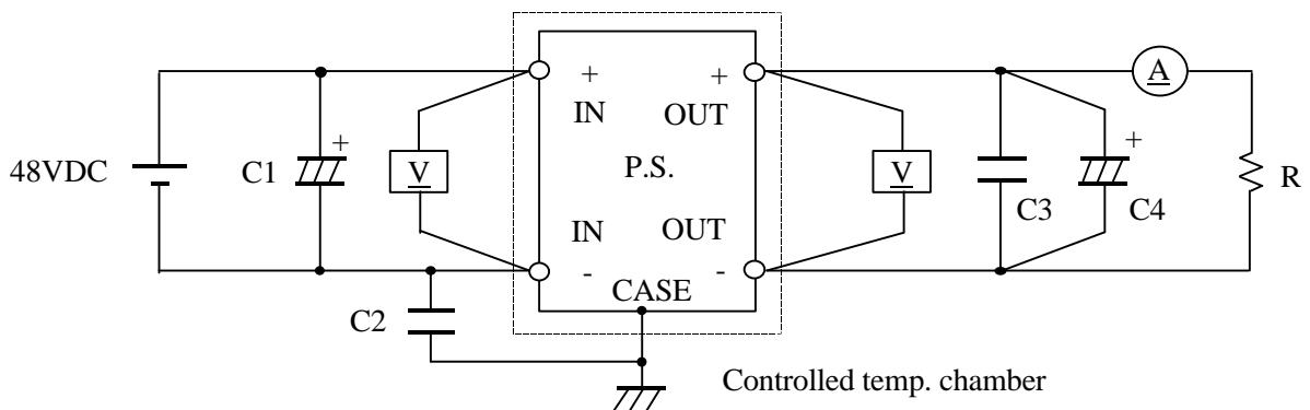
C1 : 33 $\mu\text{F}$  Electrolytic Capacitor
