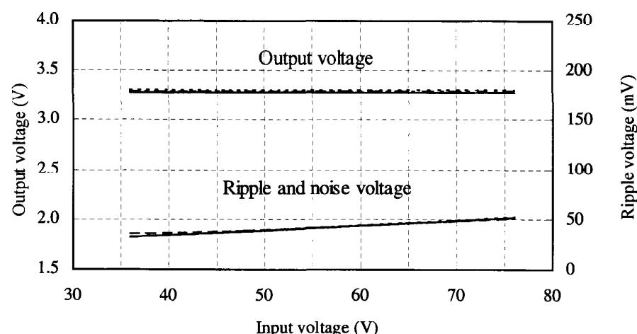
2.1 (2) 出力電圧、リップル電圧対入力電圧
