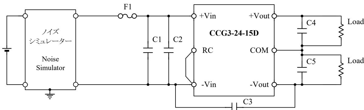
B. 信号ポート(RC、-Vin)に規定のインパルス・ノイズをコモンモードで印加する
