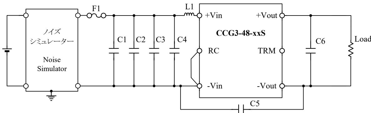
B. 信号ポート(RC、-Vin、TRM、+Vout、-Vout)に規定のインパルス・ノイズをコモンモードで印加する
