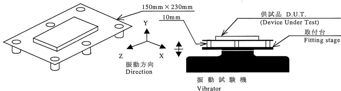
供試品を基板に取付け(入出力信号ピンをはんだ付け、M3取付用タップの4箇所をビスにより固定)、それを取付台に固定する。
