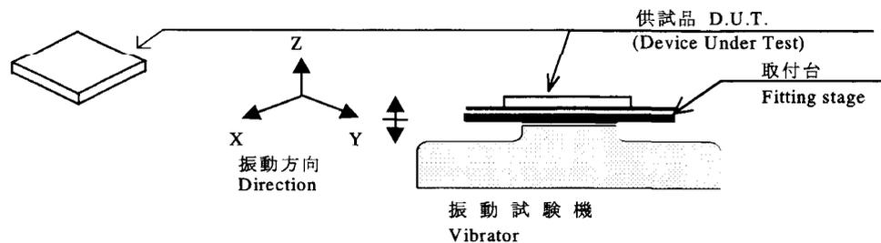
供試品をネジ(M3)で取付台に固定する。
