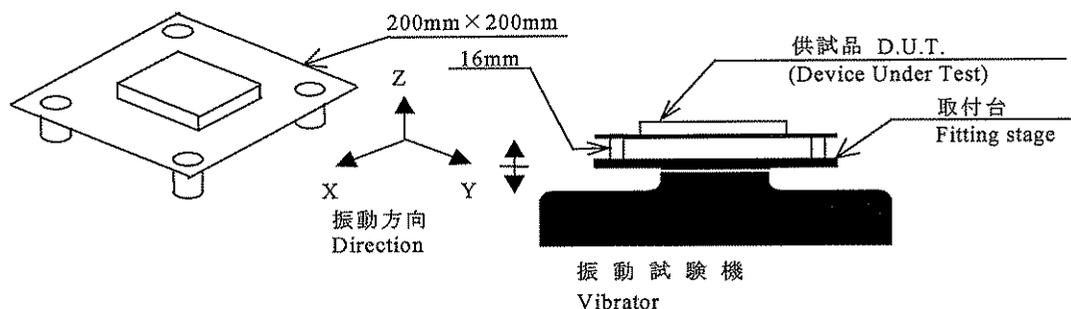
供試品を基板に取付け(入出力信号ピンをはんだ付け)、それを取付台に固定する。
